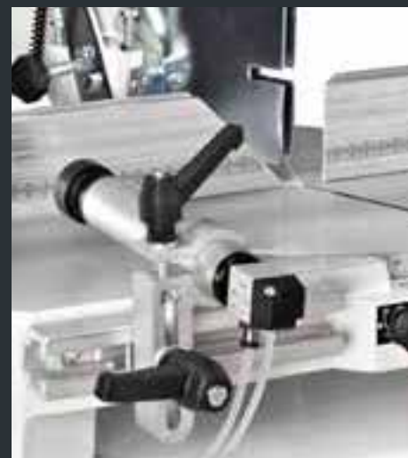
Morsa orizzontale pneumatica (2P300)
