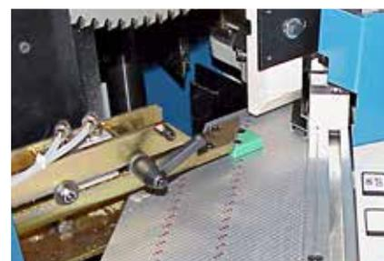
Satz vordere Spannvorrichtungen (r + l)
