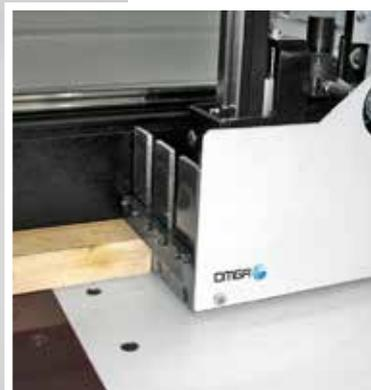
Un sistema de pinza neumática vertical instalada en el empujador, permite lograr velocidad de traslado de 240 m/min y al mismo tiempo asegura tolerancias muy exactas en el largo de corte de +/- 0,15 mm.
