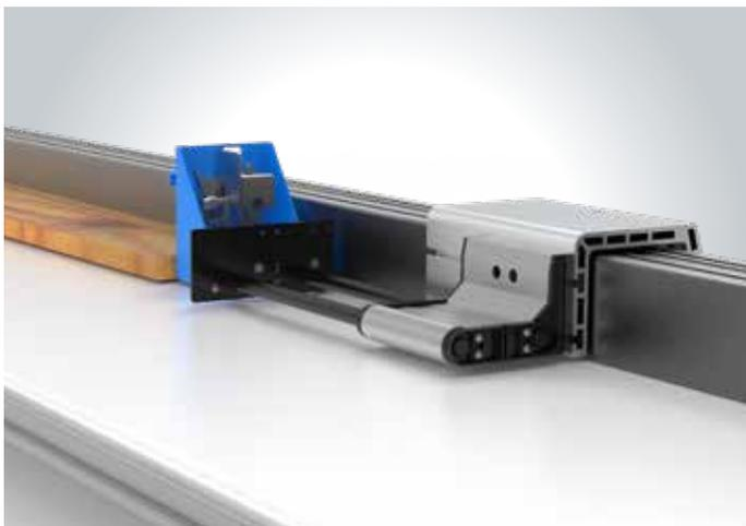
Un sistema de pinza neumática vertical instalada en el empujador, permite lograr velocidad de traslado de 60 m/min y al mismo tiempo asegura tolerancias muy exactas en el largo de corte de +/- 0,15 mm.
