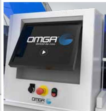
Control Numérico de última generación, con sistema operativo Windows Embedded y conectado a una pantalla Touch-Screen regulable de 19", facilita el uso sencillo y cómodo por parte de cualquier operador, reduciendo la fatiga en la vista y permitiendo un toque natural sobre la pantalla.
