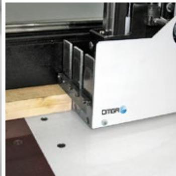
Un sistema de pinza neumática vertical instalada en el empujador, permite lograr velocidad de traslado de 240 m/min y al mismo tiempo asegura tolerancias muy exactas en el largo de corte de +/- 0,15 mm.
