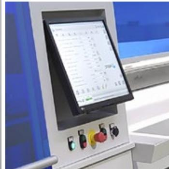
Control Numérico de última generación, con sistema operativo Windows Embedded y conectado a una pantalla Touch-Screen regulable de 19", facilita el uso sencillo y cómodo por parte de cualquier operador, reduciendo la fatiga en la vista y permitiendo un toque natural sobre la pantalla.
