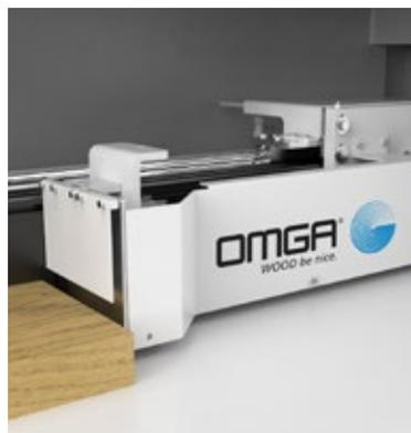
Un sistema de pinza neumática vertical instalada en el empujador, permite lograr velocidad de traslado de 120 m/min y al mismo tiempo asegura tolerancias muy exactas en el largo de corte de +/- 0,15 mm.
