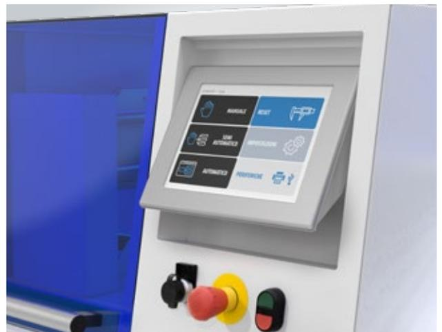
CNC integrado a una pantalla Touch-Screen de 10.4", permite una fácil introducción de datos combinado con una guía intuitiva a los diferentes programas de optimización disponibles. La pantalla regulable, facilita el uso sencillo y cómodo por parte de cualquier operador, reduciendo la fatiga en la vista y permitiendo un toque natural sobre la pantalla.
