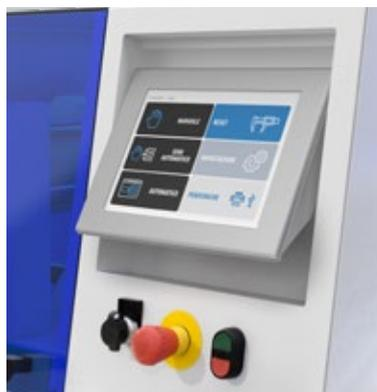
CNC integrado a una pantalla Touch-Screen de 10.4", permite una fácil introducción de datos combinado con una guía intuitiva a los diferentes programas de optimización disponibles.
