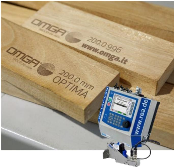
Impresora INK-JET de alta resolución, permite la impresión de escritos personalizados y logotipos, sobre las piezas cortadas. El sistema utiliza cartuchos de HP, los que lo hacen muy confiable e de muy fácil manutención. El control de la impresora está integrado en el software de gestión.
