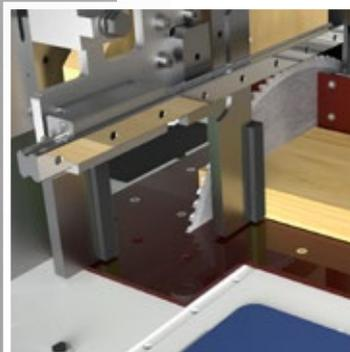
Detalle de la zona de corte con prensos verticales y horizontales inteligentes que deslizan sobre cojinetes y guías rectilíneas de alta precisión. La cobertura transparente en policarbonato garantiza una clara visión de las operaciones de corte y permite un fácil acceso para mantenimiento, gracias al sistema de elevación asistido.
