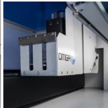
Un sistema de pinza neumática vertical instalada en el empujador, permite lograr velocidad de traslado de 120 m/min y al mismo tiempo asegura tolerancias muy exactas en el largo de corte de +/- 0,15 mm. La pinza se levanta durante el recorrido de regreso permitiendo la lectura de la piezas y sus marcas.
