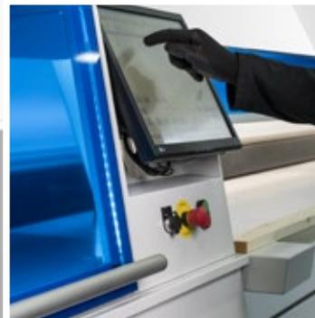
Control Numérico de última generación, con sistema operativo Windows Embedded y conectado a una pantalla Touch-Screen regulable de 17", facilita el uso sencillo y cómodo por parte de cualquier operador, reduciendo la fatiga en la vista y permitiendo un toque natural sobre la pantalla.
