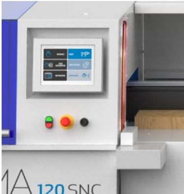
Barrera de seguridad: permite al operador de trabajar con en la máxima seguridad bloqueando inmediatamente el carro empujador, al detectar cualquier objeto; la barrera en ciclo con la máquina se desactiva automáticamente cuando el empujador se encuentre en zona de seguridad, permitiendo al operador de cargar la nueva barra.
