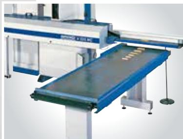
Cinta transportadora de paso neumático 2000 x 600 mm
