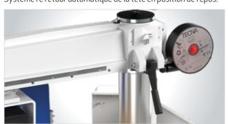
Dispositifs de verrouillage à centrage automatique pour la rotation du bras  $(+45^{\circ}-45^{\circ})$  et la position d'angle du moteur  $(45^{\circ}$  sur la gauche).
