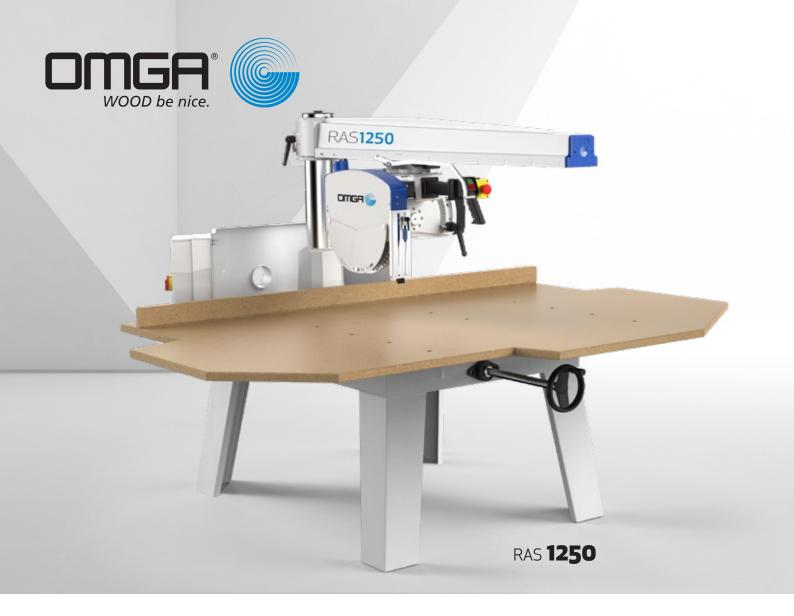
Ligne robuste avec structure en acier solide et bras en fonte. L'unité de coupe coulisse sur des glissières facilement interchangeables par 8 roulements. Commande de soulèvement et abaissement du bras sur le devant, est standard sur la RAS 1250.
