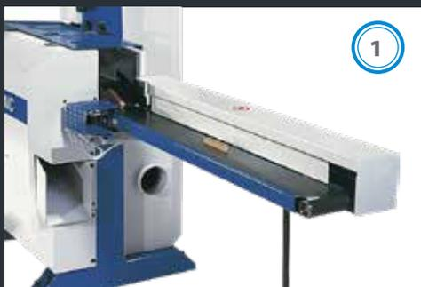
Tappeto di scarico con espulsore
